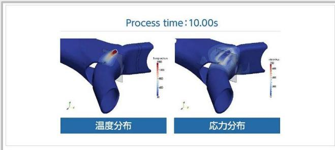
JWELDは、金属同士をくっつける「溶融溶接」と、摩擦の力で混ぜ合わせて接合する「摩擦攪拌接合（FSW）」という2種類の生産技術を対象とし複数のパッケージ群から構成
